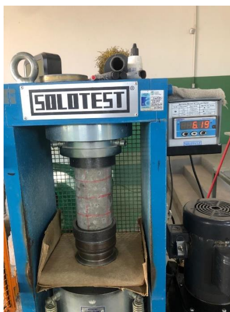
FIGURA 5 – Ensaio de resistência à compressão utilizando prensa hidráulica
