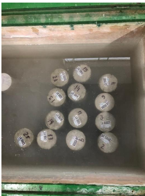
FIGURA 3 - Cura úmida dos corpos de prova em tanques
