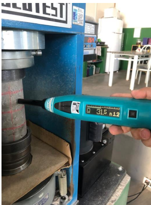
FIGURA 4 – Ensaio de esclerometria na superfície lateral do corpo de prova de concreto
