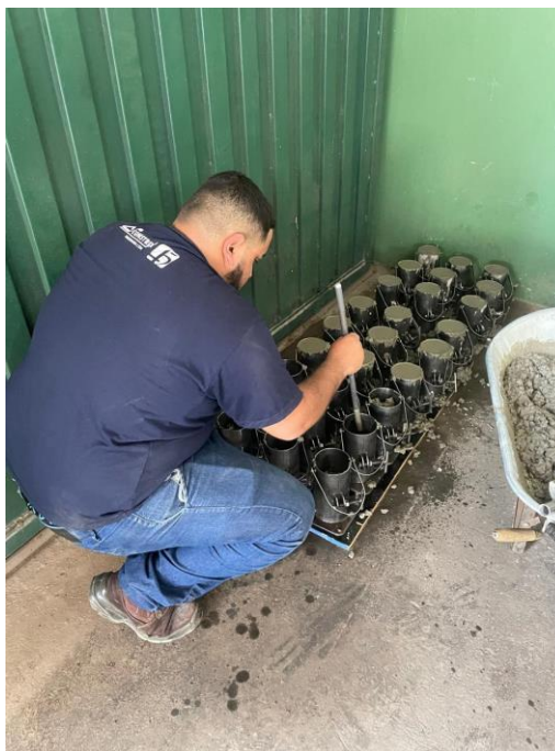
FIGURA 2 - Moldagem dos corpos de prova
