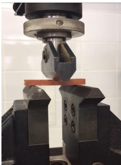
FIGURA 8 - Ponto de apoio dos corpos de prova e cutelo de ruptura do flexômetro
