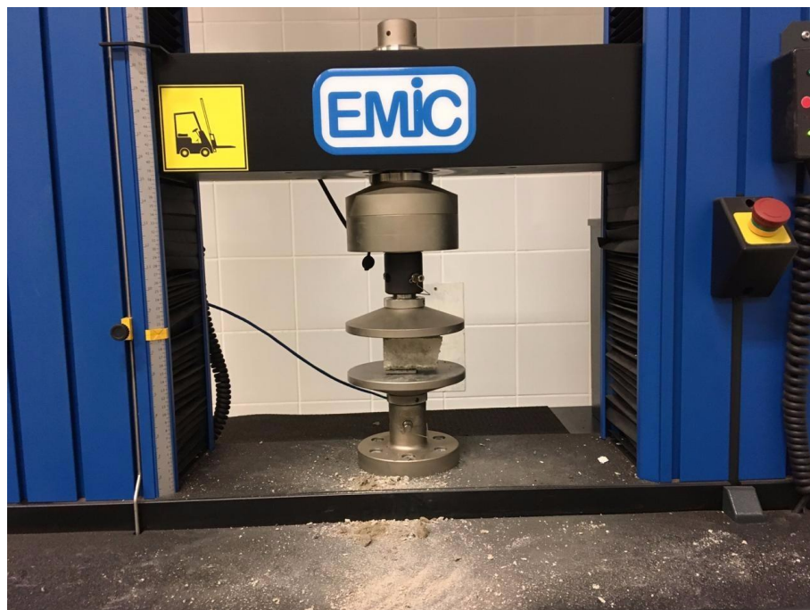
FIGURA 14 - Ensaio de compressão de argamassa
