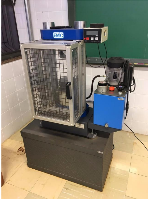
FIGURA 13 - Equipamento de ensaio mecânico de compressão
