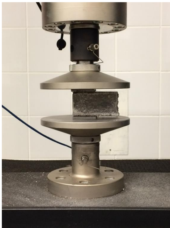
FIGURA 13 – Equipamento Realizando Ensaio de Compressão Axial
