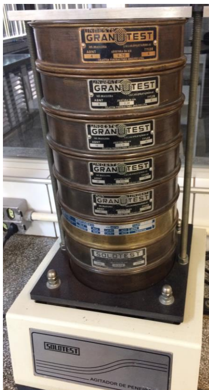
FIGURA 4 - Peneiras para Ensaio de Análise Granulométrica
