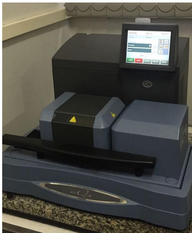
FIGURA 6 - Equipamento Utilizado para Análise de Calorimetria Exploratória Diferencial
