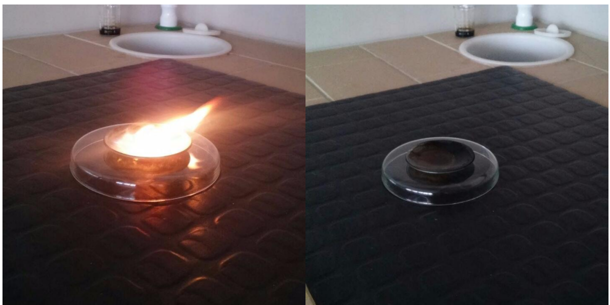
FIGURA 09 – A esquerda, vidro de relógio durante teste de inflamabilidade. A direita, vidro de relógio após a queima total do resíduo
