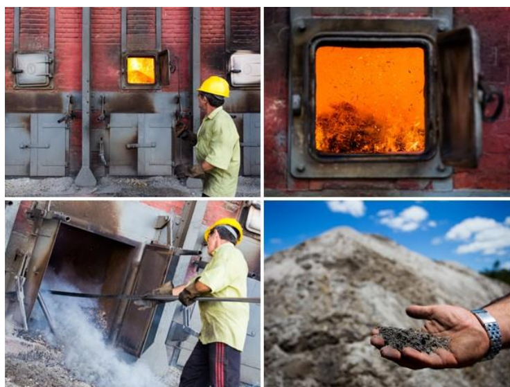
FIGURA 1 - Queima do bagaço da cana-de-açúcar produzindo as cinzas
