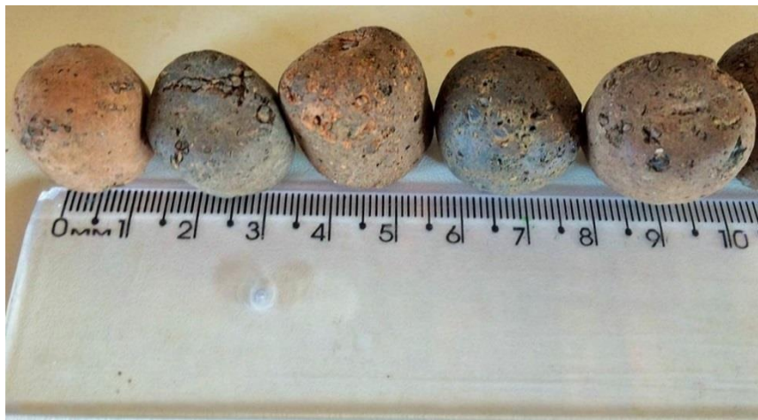
FIGURA 10 – Verificação da dimensão da argila expandida.
