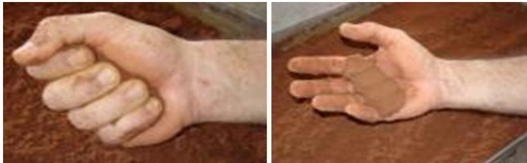
FIGURA 16: Teste expedito para verificação da umidade adequada de compactação.
