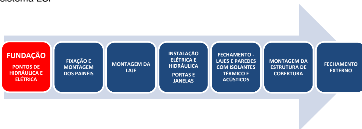
FIGURA 21 : A figura abaixo apresenta o fluxograma das etapas construtivas do sistema LSF
