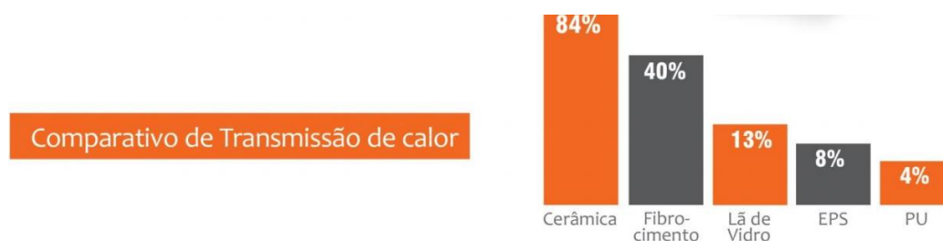
FIGURA 42 – telhas e sua transmissão de calor
