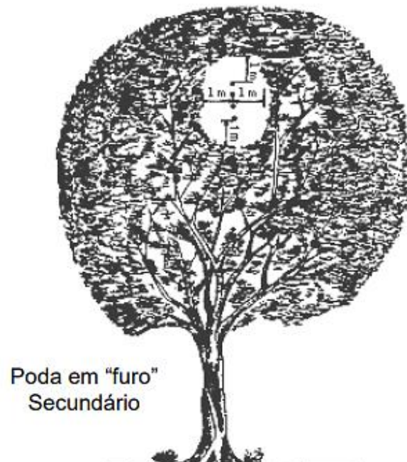
FIGURA 09 – Poda em furo, retira-se no meio de 1 metro apenas os ramos que se direcionam à rede.
