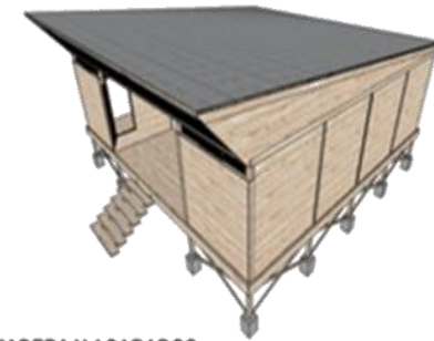
PANELES DE MADERA Y ACABADOS MÓDULO COMPLETO 10 DIAS
