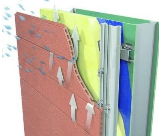
FIGURA 108: Efeito chaminé da fachada ventilada
