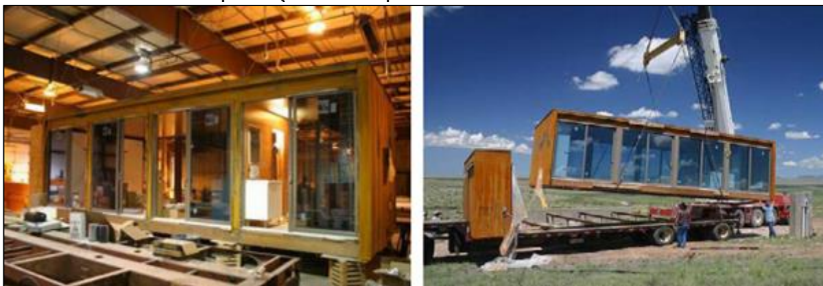
FIGURA 45 - linha de produção e transporte da WeeHouse
