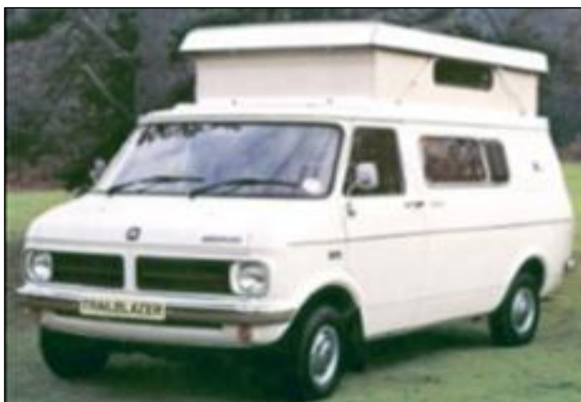
FIGURA 35 – Trailblazer , 1976 em uma Bedford CF220 com novo projeto de elevação do telhado
