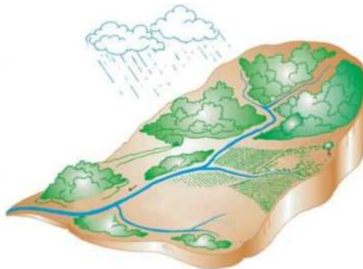
Figura 4 - Representação em perspectiva de uma bacia hidrográfica
