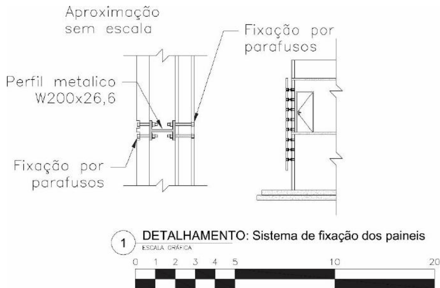
Figura 95 - Detalhamento: Sistema de fixação dos painéis
