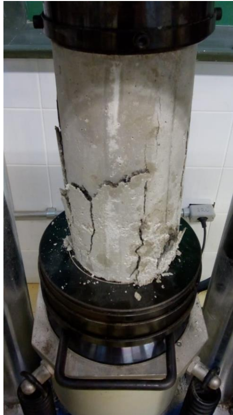
FIGURA 7 - Ruptura dos corpos de prova.
