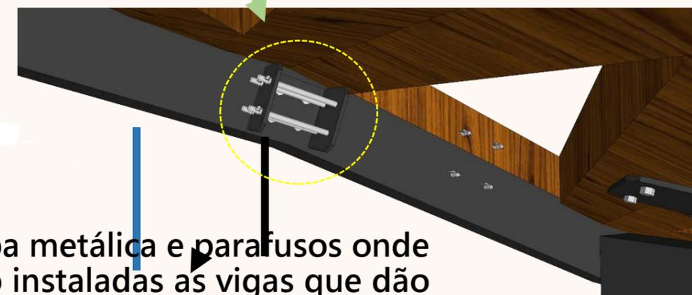
Chapa metálica e parafusos onde serão instaladas as vigas que dão suporte às estruturas triangulares
