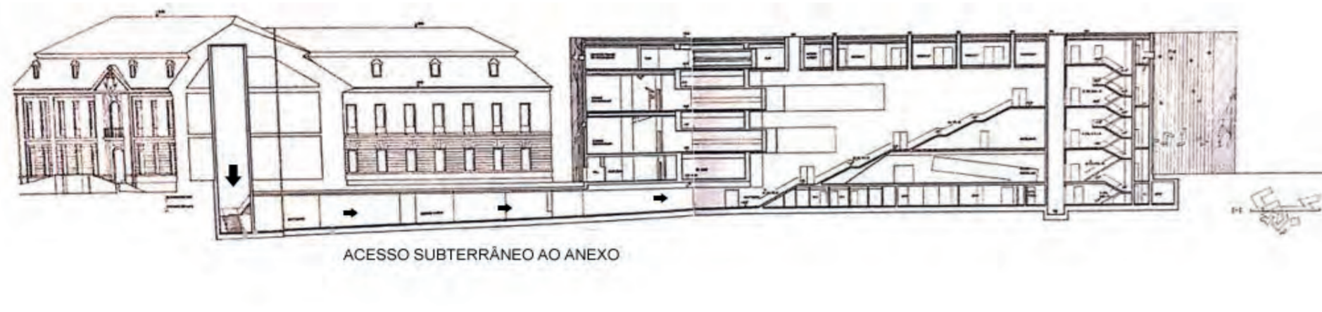
Fig. 10 – Corte mostrando acesso do anexo.
