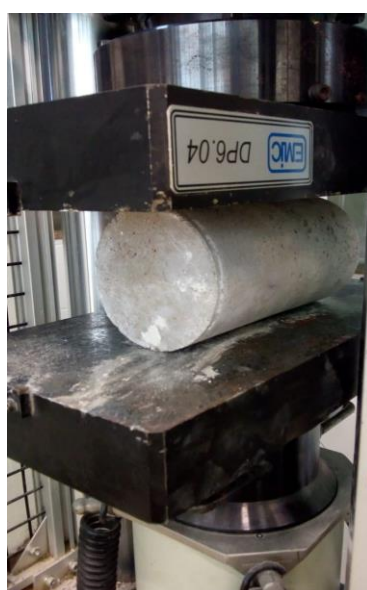
Figura 23 - Ensaio de compressão diametral. Fonte: Autor, 2020.
