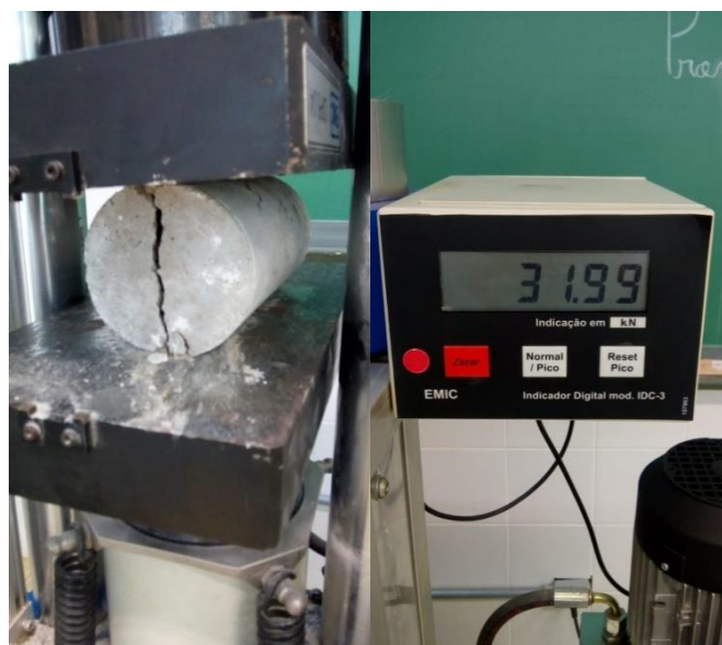
Figura 24 - Rompimento do corpo de prova. Fonte: Autor, 2020.
