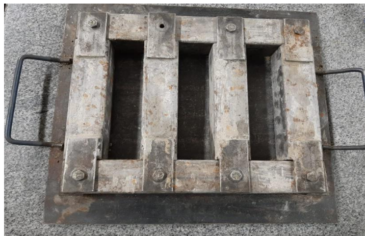
Figura 10 - Forma dos copos de prova prismáticos. Fonte: Autor, 2020
