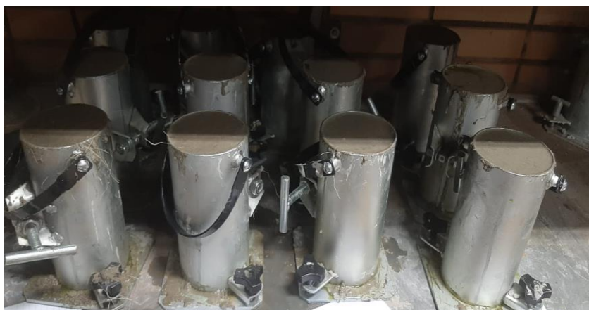
Figura 12 - Armazenamento dos corpos de provas. Fonte: Autor, 2020.
