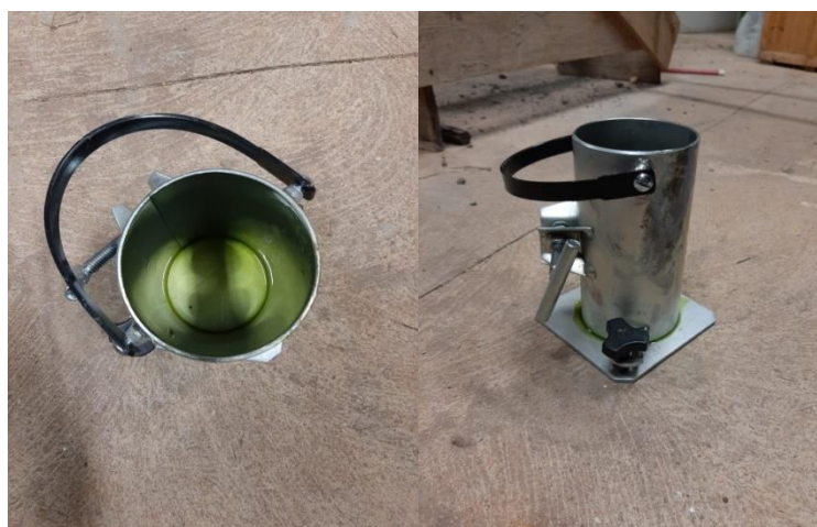
Figura 9 - Forma do Corpo de prova cilíndrico. Fonte: Autor, 2020
