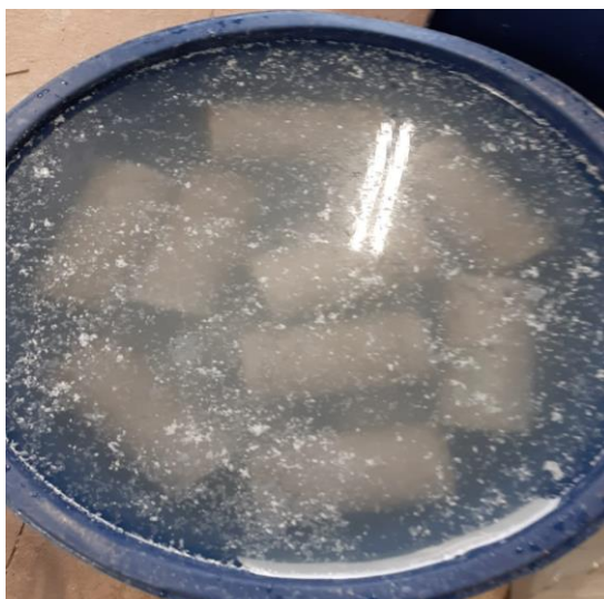
Figura 15 - Corpos de provas submersos. Fonte: Autor, 2020.
