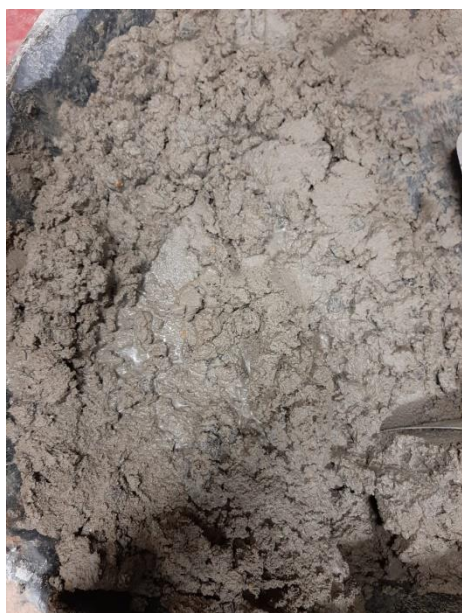
Figura 7-Concreto sem fibras. Fonte: Autor, 2020.
