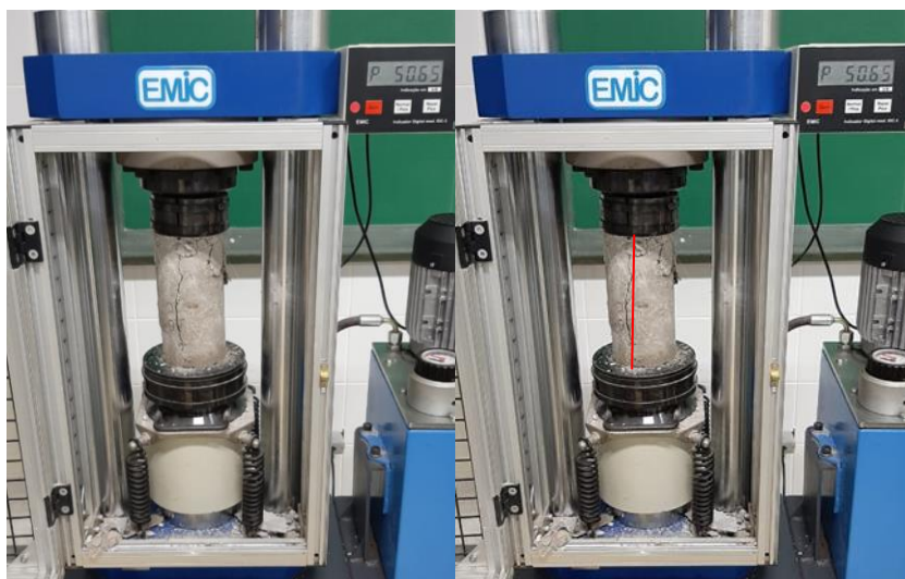
Figura 20 - Ruptura colunar. Fonte: Autor, 2020
