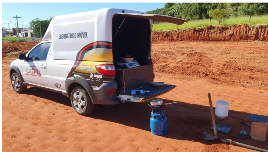
Figura 42 – Controle de qualidade da base através de laboratório móvel
