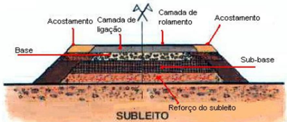
Figura 39 – Detalhe esquemático da pavimentação asfáltica flexível
