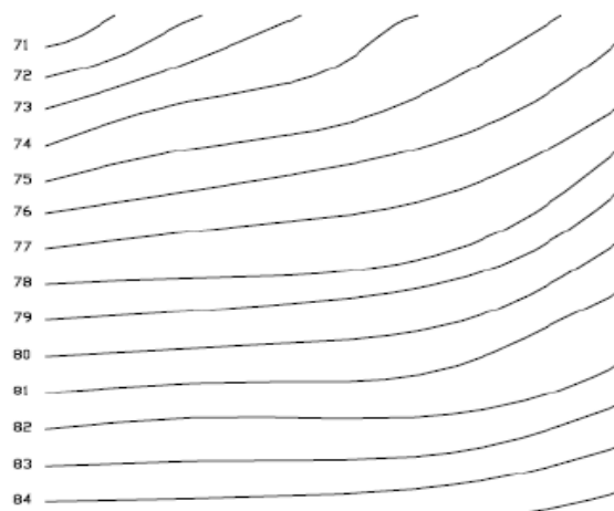
Figura 3 - Curvas de nível típicas de terreno plano
