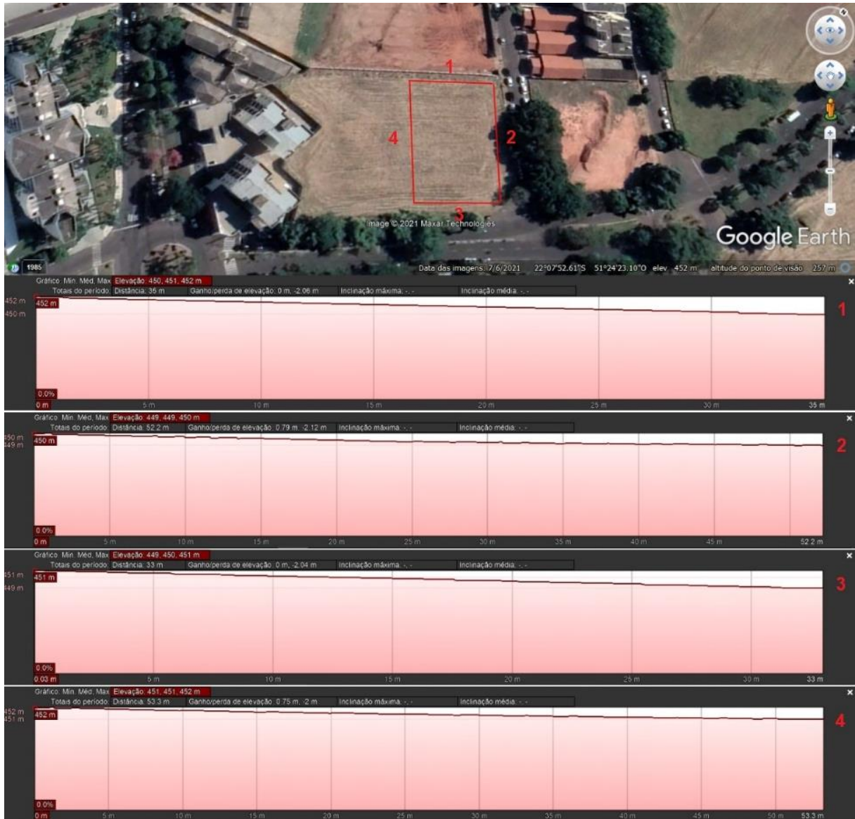
Figura 47 – Cortes do Terreno
