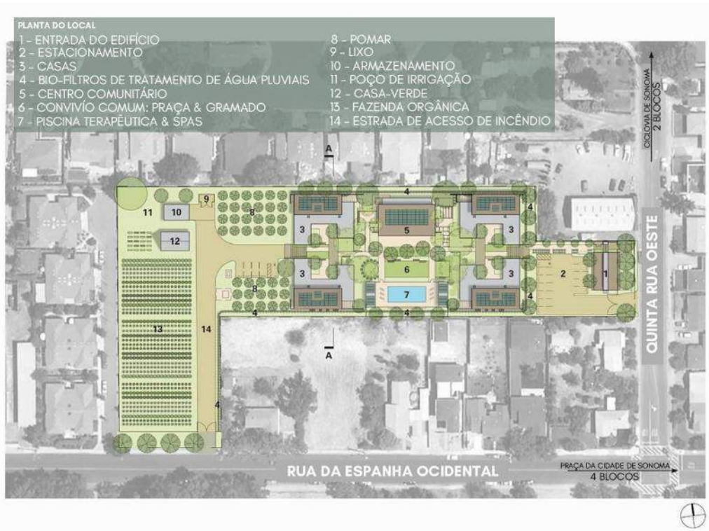
Figura 17 - Planta de implantação da habitação
