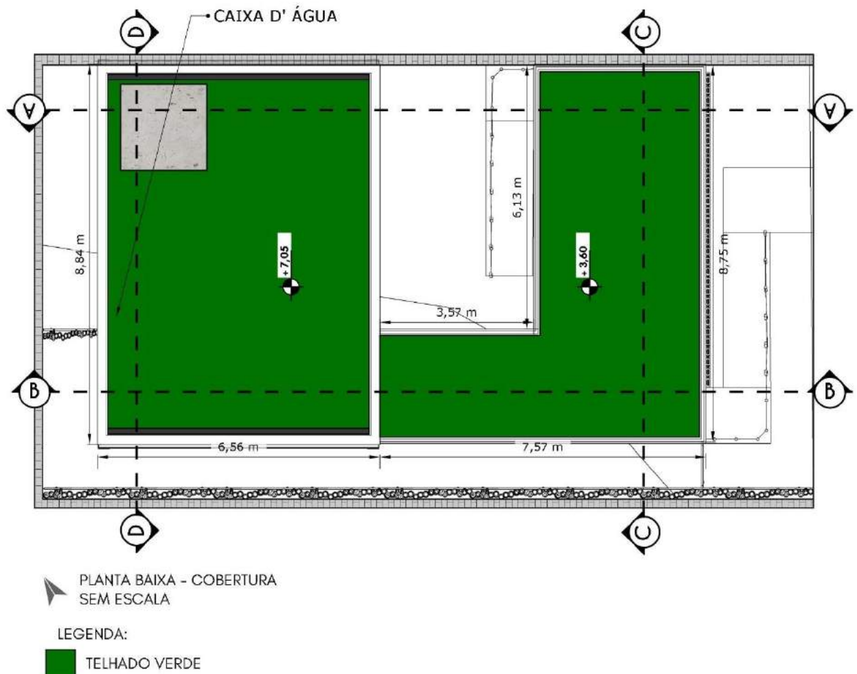
Figura 67 - Planta baixa da cobertura
