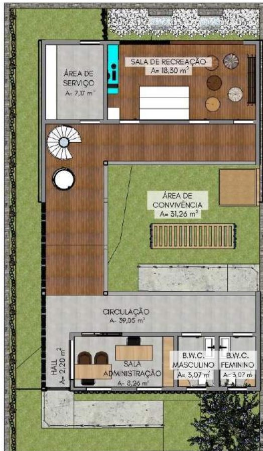
Figura 78 - Planta layout do primeiro pavimento
