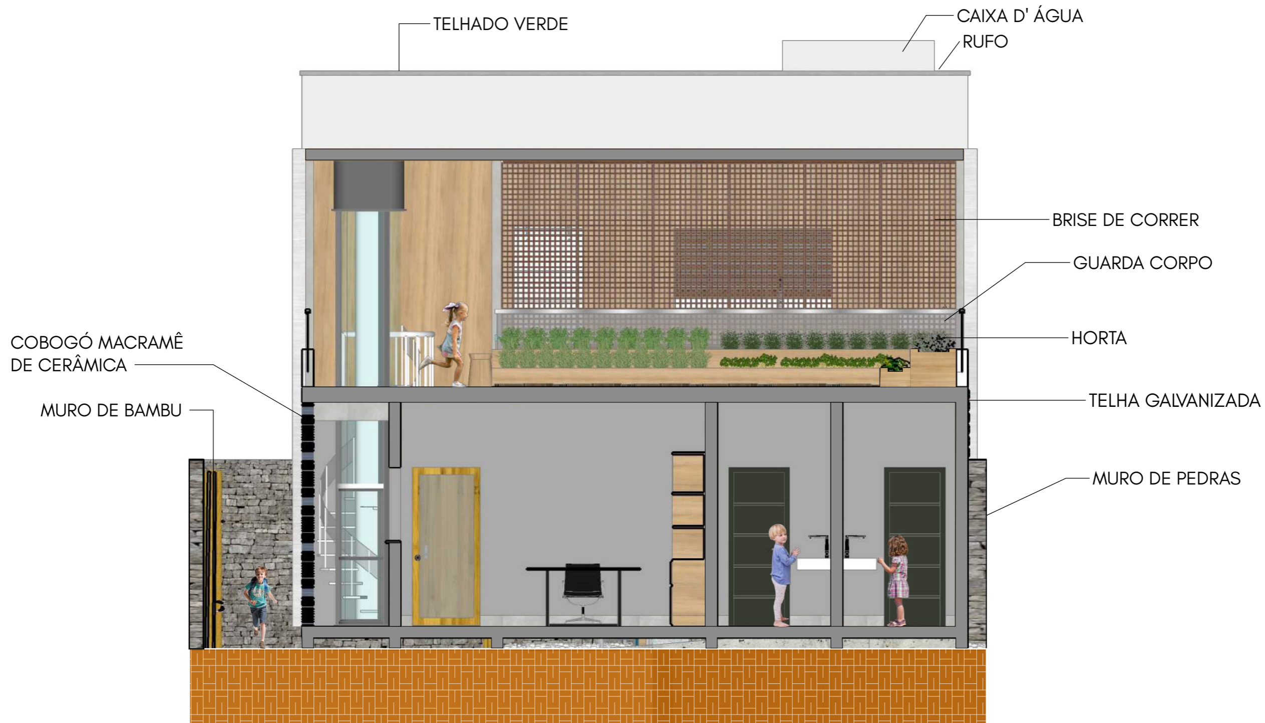
CORTE CC - HUMANIZADA ESCALA 1:50
