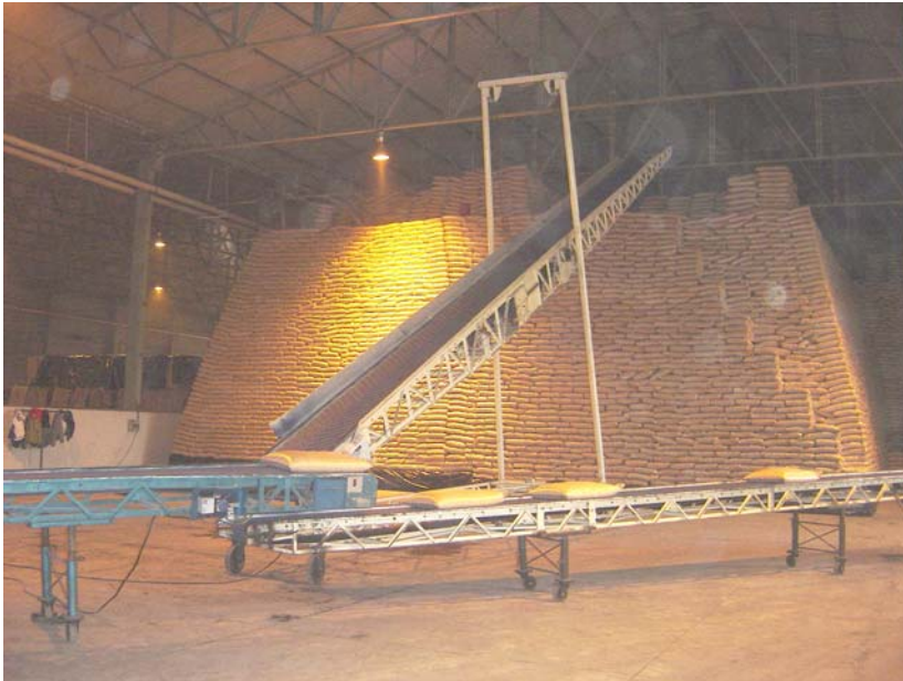
FIGURA 03 - EMPILHADORES DE SACARIAS
