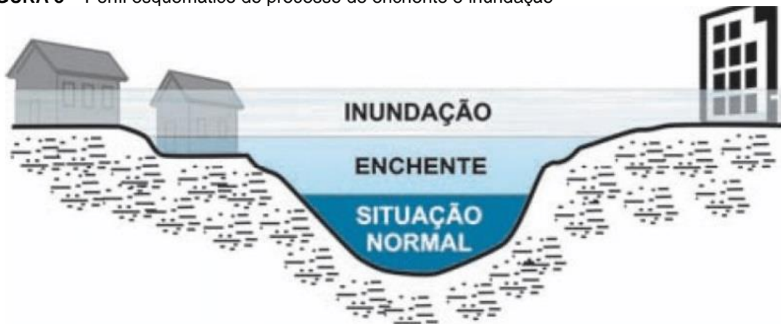
FIGURA 3 – Perfil esquemático do processo de enchente e inundação
