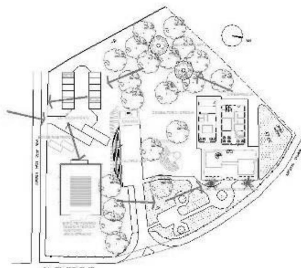
Figura 4 – Projeto dos dois anexos ao edifício do museu, visando o acesso aos fluxos, deslocando-se da rotatória de veículos
