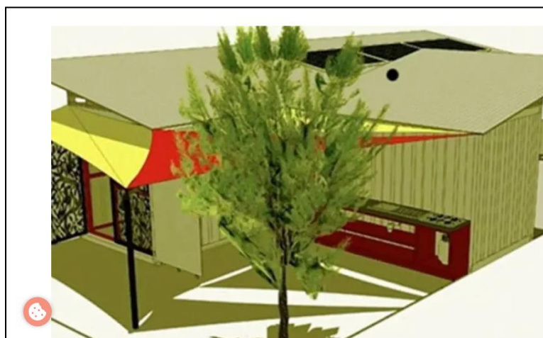
Figura 1 - Aspecto de uma casa construída com container para os desabrigados.
