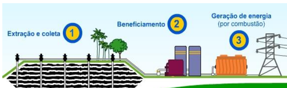
Figura 4: Processo de geração de energia por meio do lixo
