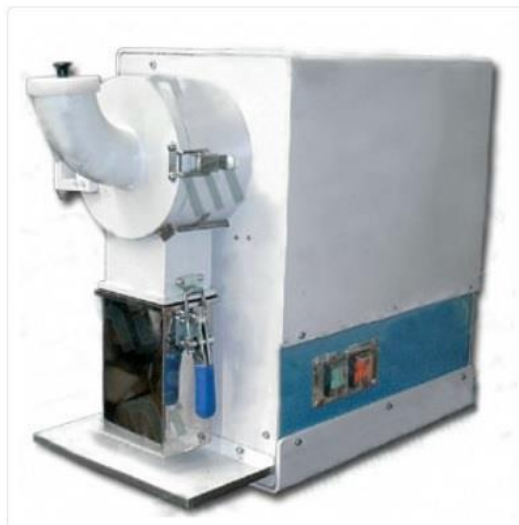
Figura 6: Moinho de martelo MA-880 de marca Marconi.
