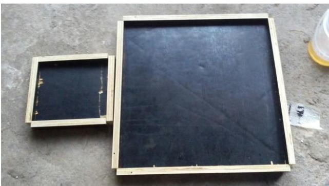
Figura 3. Formas utilizadas para moldar as placas.
