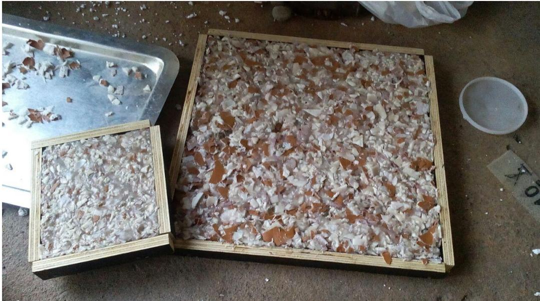
Figura 6. Processo de moldagem das placas.
