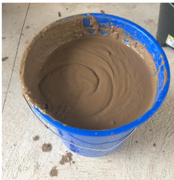
FIGURA 5 - Lodo homogeneizado de forma manual.
