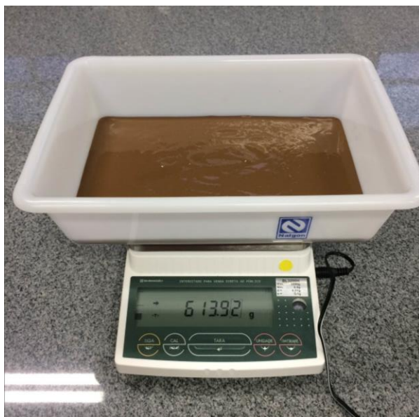
FIGURA 7 - Amostra A de lodo passada para bandeja Nalgon e pesada em balança semi-analítica.
