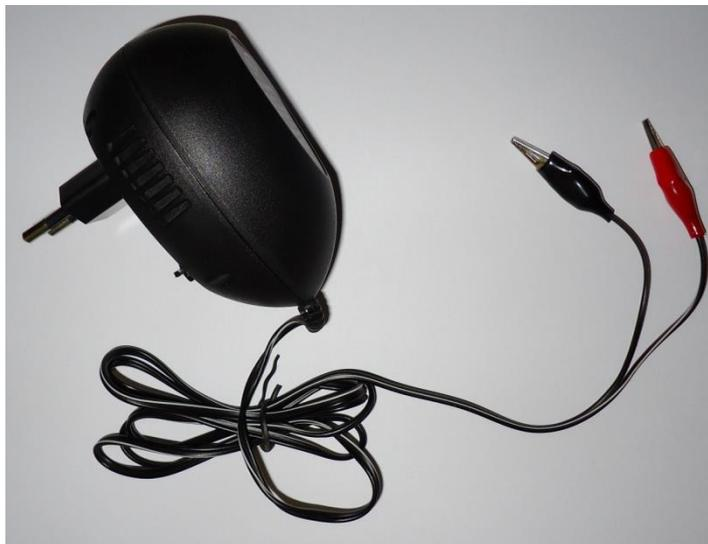
**FIGURA 1** – Fonte escalonada AC/DC de até 12V.
