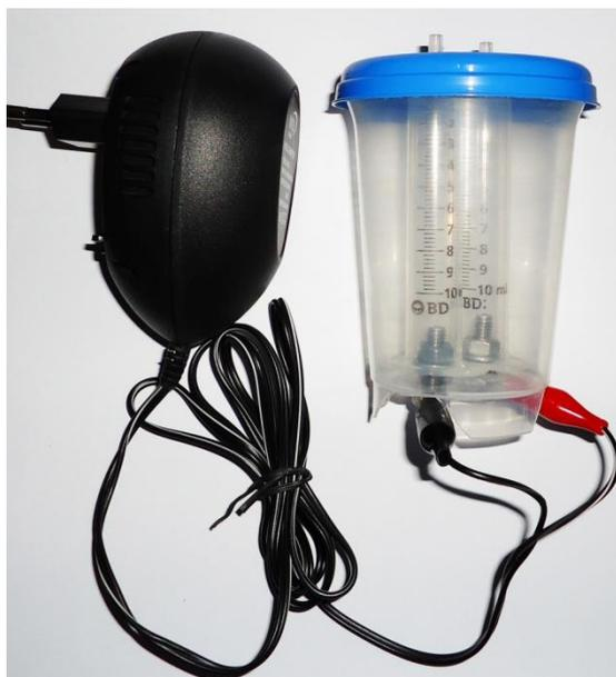
**FIGURA 6** – Sistema para eletrólise terminado.
