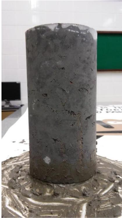
*Figura 3: Capeamento do corpo de prova*
