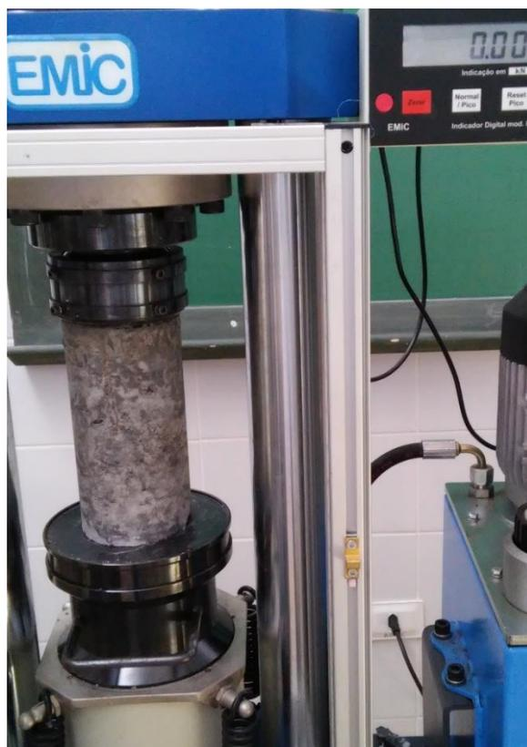
*Figura 4: Ensaio de resistência mecânica sendo realizado*
