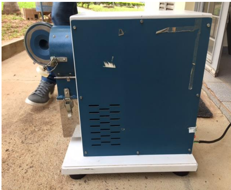
FIGURA 5 - Destorroamento no Moinho de martelo.
