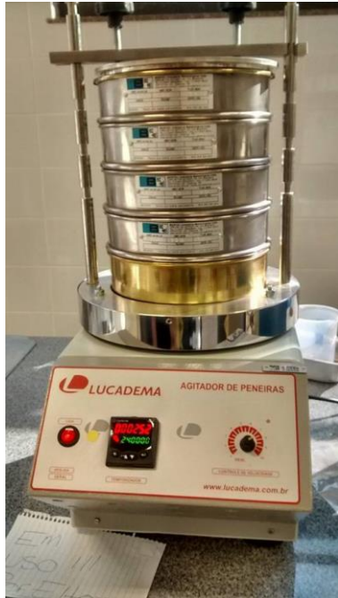
Figura 3- Agitador de peneiras do laboratório de materiais da Toledo Prudente
