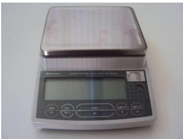
Figura 5- balança semi-analítica digital da marca Shimadzu modelo BL-3200H
