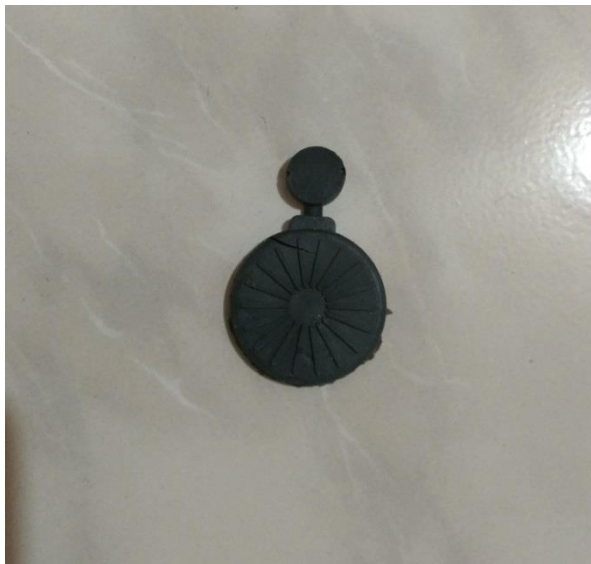
Figura 10: Corpo de prova obtido após o ensaio realizado no reômetro de torque, com 20 gramas de cinza do bagaço da cana.
