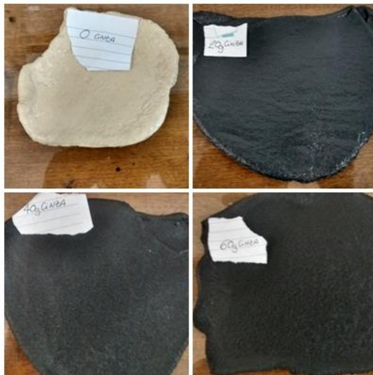
Figura 9: Massas aceleradas através do processo de mastigação com adição de 0, 20, 40 e 60 gramas de cinza do bagaço de cana.
