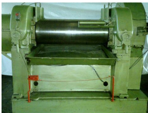
Figura 6: Cilindro misturador aberto Makintec modelo 379m.
