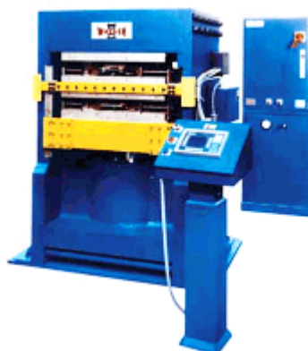
Figura 11: Termo prensa para vulcanização das massas aceleradas.
