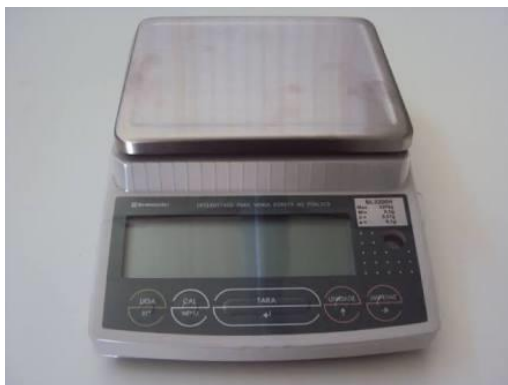
Figura 7: Balança semi-analítica Shimadzu utilizada para pesagem dos materiais.
