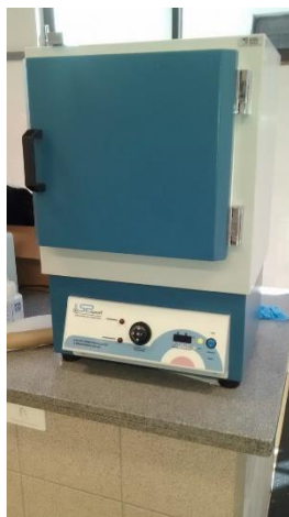
Figura 3: Processo de secagem da cinza do bagaço de cana a uma temperatura de 100°C.
