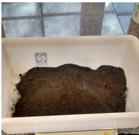
Figura 2: Cinza do Bagaço da Cana em sua forma bruta antes do processo de separação das granulometrias.
