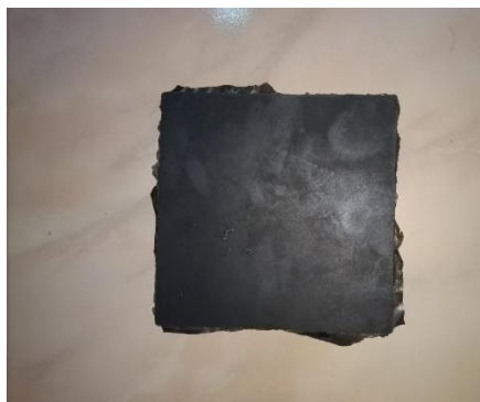
Figura 12: Compósito produzido com 20 phr de cinza do bagaço de cana.
