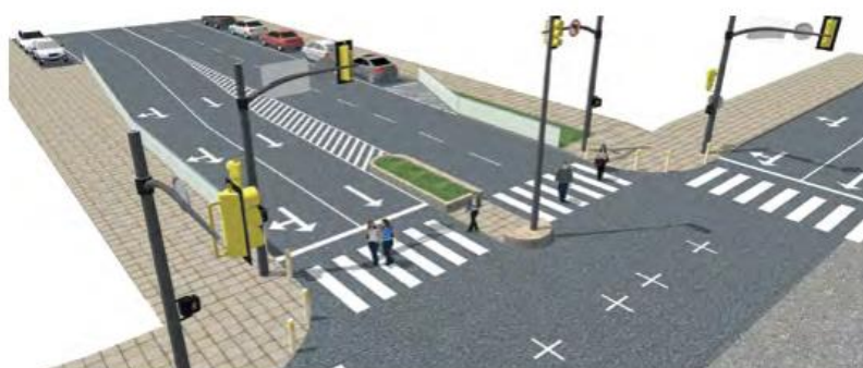
Refúgio no canteiro central sem continuidade do canteiro
