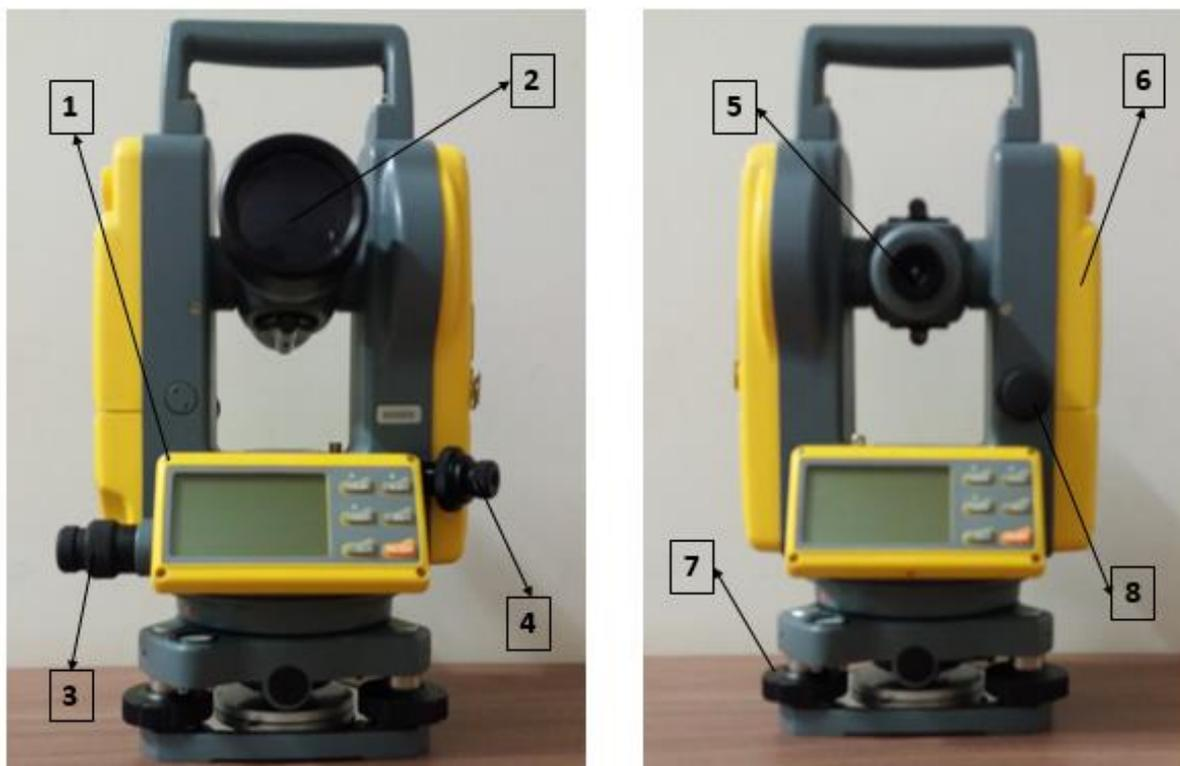
O método proposto foi conduzido em cinco etapas, com a finalidade de detalhar cada uma das operações realizadas durante os seguintes procedimentos: instalação do teodolito eletrônico, centragem, nivelamento, focalização e pontaria, e por fim, a leitura de ângulos. Cabe ressaltar que o método do presente trabalho tem como base as abordagens apresentadas por Veiga *et al.* (2012).
