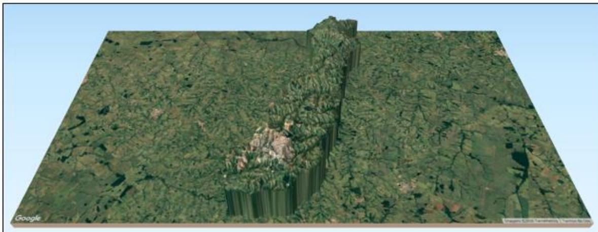
Figura 7 – (a) Modelo tridimensional do terreno a partir da imagem SRTM classificada, (b) modelo tridimensional do terreno com a sobreposição de imagens da plataforma *Google Satellite*.
