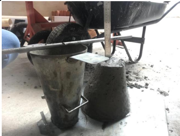
Figura 2 - Ensaio de abatimento de tronco de cone
