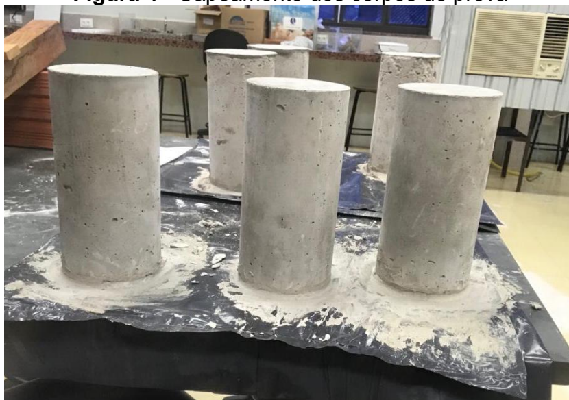
Figura 4 - Capeamento dos corpos de prova
