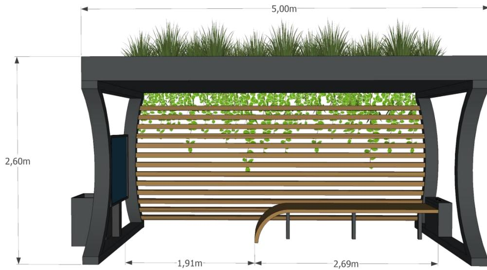
**Figura 14** – Vista frontal – Modelo de ponto de parada com modulação flexível para atender maior numero de usuários.
