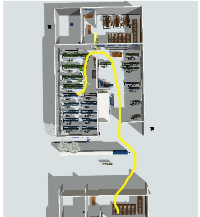
Figura 13: Novo Diagrama de Espaguete proposto para peças semiacabadas (Fonte: Dados da pesquisa)
