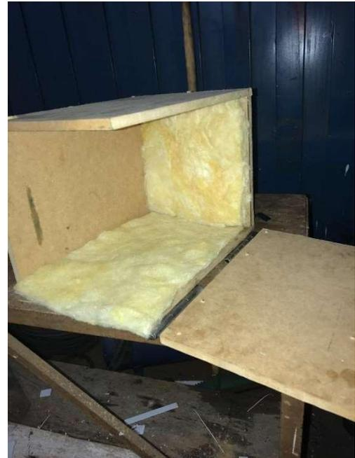
*Figura 11: Corpo Estrutural junto com a lã de vidro. Fonte: Imagem de smartphone.*
