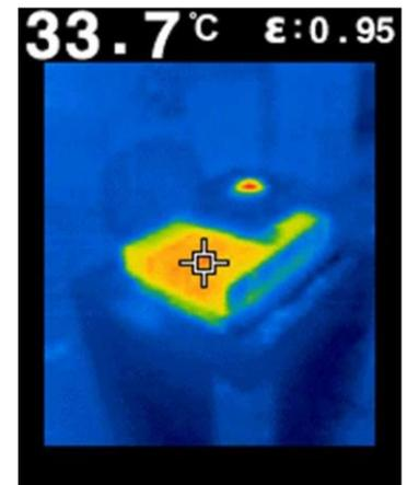
*Figura 17:Foto térmica do projeto final exibindo a geladeira fechada. Detalhe aponta para temperatura de dissipador externo com 33,7°C. Fonte: Câmera térmica FLIR TG165 (Toledo).*
