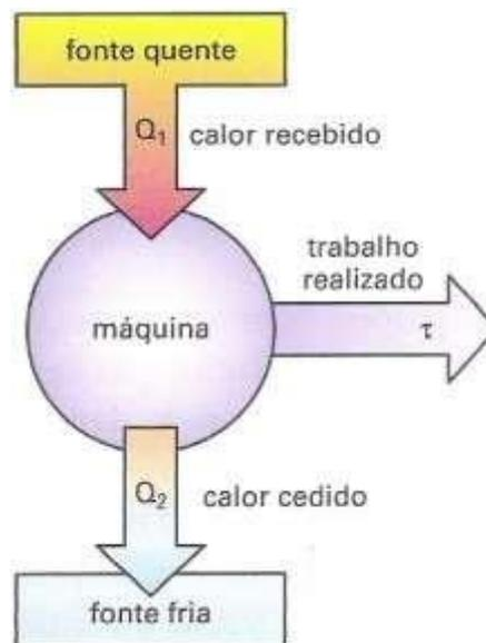
Figura 06 – Representação ilustrada do funcionamento de uma máquina térmica
