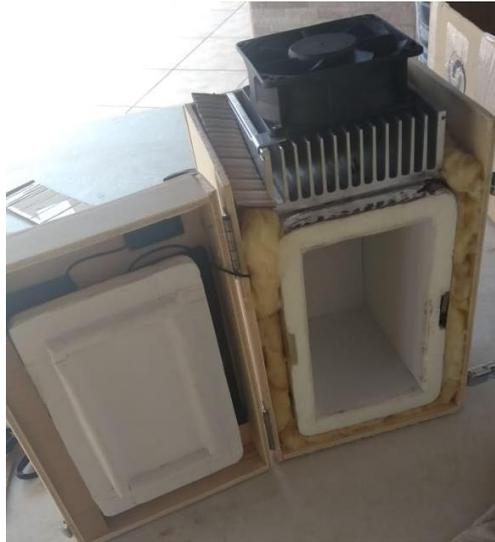
**Imagem 6.** Foto da caixa térmica de isopor fixada na caixa de MDF com seus revestimentos e instalações elétricas. Na porta, o termômetro já instalado. Fonte: Registro próprio.
