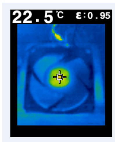
**Imagem 11.** Foto térmica do cooler e dissipador externo. Detalhe aponta para temperatura de 22,5°C. Fonte: Câmera térmica FLIR TG165 (Toledo).
