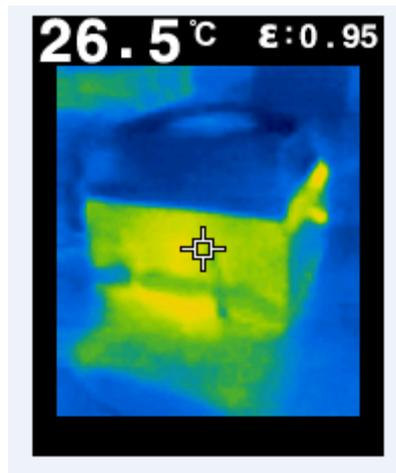
**Imagem 10.** Foto térmica do cooler e dissipador externo. Detalhe aponta para temperatura de 26,5°C. Fonte: Câmera térmica FLIR TG165 (Toledo).
