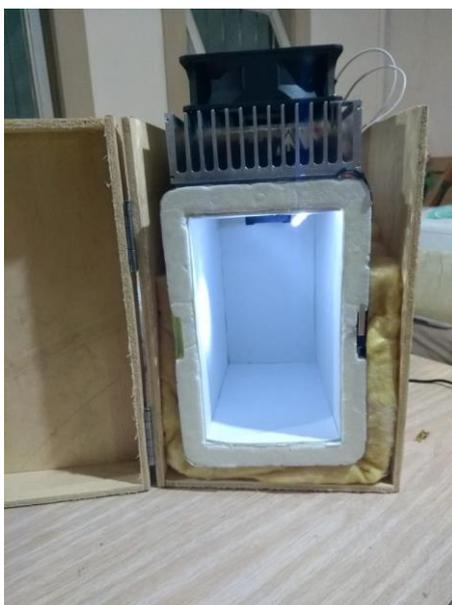
**Imagem 5.** Foto da caixa térmica de isopor fixada na caixa de MDF e revestida com fita alumizada, EVA e lã de vidro, com fonte, led, dissipadores, coolers e placa de Peltier já fixadas. Fonte: Registro próprio.
