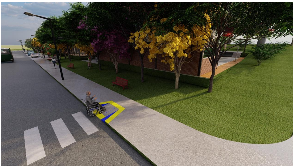
Figura 5 – Figura da faixa de pedestres com guia rebaixada
