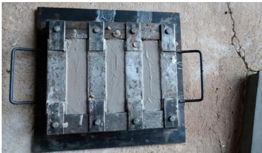
Figura 3: Corpo de prova da argamassa com o aditivo Vedalit
