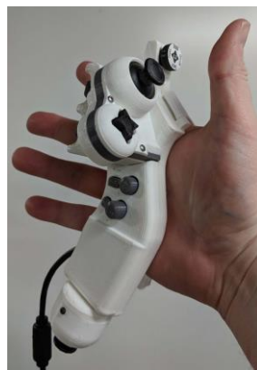
Figura 2: Protótipo de uma mão completo para PS4 Fonte: Ben Heck, 2019.
