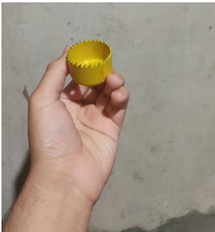
Figura 1: serra copo responsável pela perfuração.
