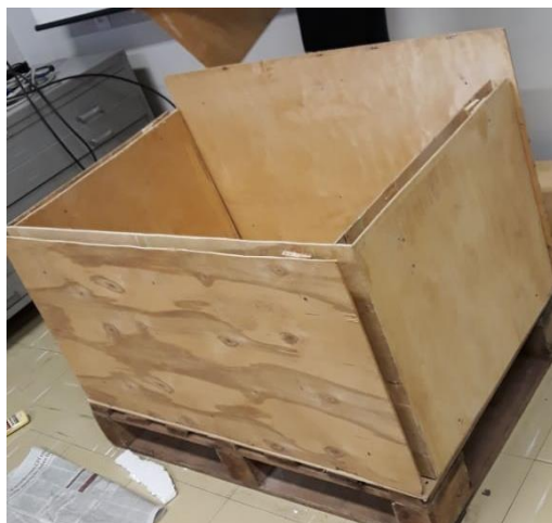
Figura 6 – montagem das paredes.
