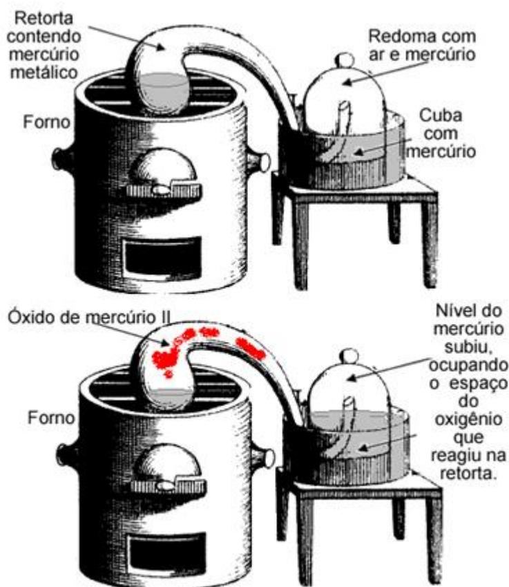
**Figura 1** – Calcinação do mercúrio em uma retorta.
